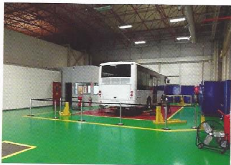
▲ Na testni mizi simulirajo vožnjo, ki v treh mesecih prikaže rezultate do milijona prevoženih kilometrov
