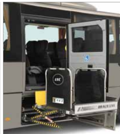
VORBEREITUNG FÜR DEN EINBAU EINES ROLLSTUHLLIFTES AN DRITTER TÜR IN DER FAHRZEUGMITTE
